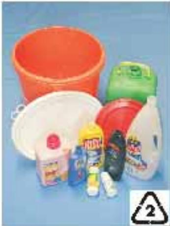
HDPE- und PE-Verpackungen werden zu "Mahlgut" zerkleinert, gewaschen, erhitzt und durch eine Art "Faschiermaschine" gepresst. Aus den so entstandenen kleinen Plättchen (=Granulat) können wieder neue Kunststoffprodukte hergestellt werden.
